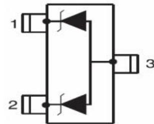
**■Internal Schematic Diagram 内部结构****■Device Marking 产品打标**
